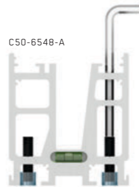
Опция с регулируем блок за неравна повърхност
